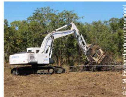
Mit dieser gepanzerten Maschine bereitet Sarneta ohne Gefahr das Gelände für die Entminung vor.
