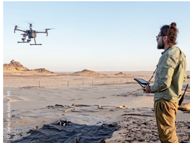
Um die humanitäre Minenräumung zu beschleunigen, wurden auch im Tschad spezielle Drohnen mit Sensoren erfolgreich getestet.
